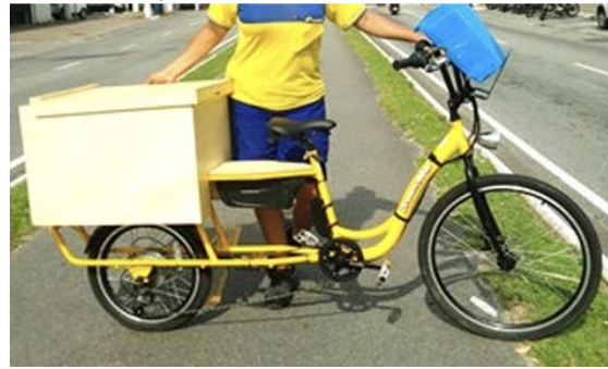
Figura 6. Modelos de bicicletas elétricas cargueiras desenvolvidos por empresa parceira, para experimentação dos correios, no município de Praia Grande - SP. Fonte: Aliança Bike
